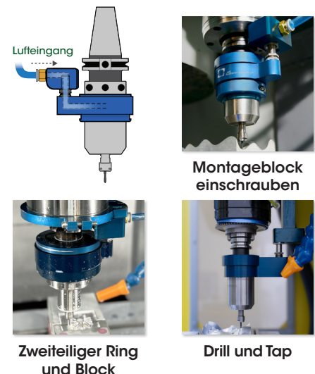
Abbildung 6: Da verschiedene Block- oder Ringkombinationen verfügbar sind, ermöglicht die TMA Air Turbine Spindle®-Montageoption einen automatischen Werkzeugwechsel auf jeder CNC.
